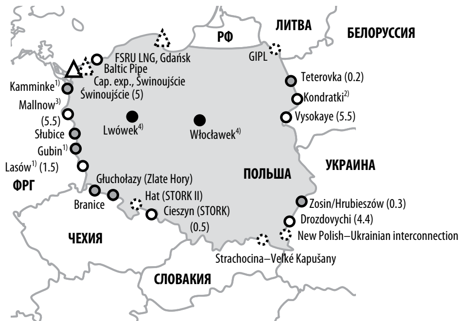
Рисунок 2. Входы для трансграничного трубопроводного газа и возможности импорта СПГ в Польшу
